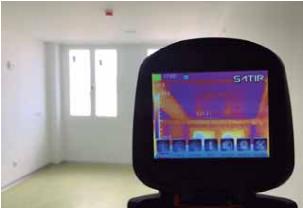
La instalación en ambos techos es de doble tubo, es decir, funciona tanto como sistema de calefacción como de refrigeración
