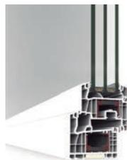
Cortizo PVC presenta la nueva serie A 84 Passivhaus 1.0, un sistema abisagrado de 84 mm de profundidad y perfilaría de 6 cámaras interiores con refuerzo de acero con rotura de puente térmico. Esta ventana ha sido certificada para la categoría *warm-temperate*
