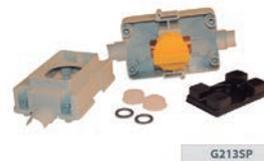
sistemas de gas ocultos con conexiones roscadas macho de asiento plano. Está realizada en latón no cromado y se encuentra albergada en una caja de contención de plástico que incluye soportes de acero ajustables. El mango es de plástico amarillo, color indicativo de las instalaciones de gas. Además, está reforzada con juntas de plástico y un plástico protector para los sitios de construcción.
