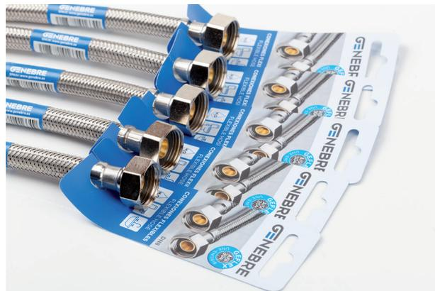
cción macho fijo - tuerca hembra giratoria de acero inoxidable AISI 304, roscas según ISO 7/1 (UNE-EN 10226). Junta plana de EPDM. Presión máxima de trabajo 16 bar. Temperatura de trabajo -10°C a 100°C.
