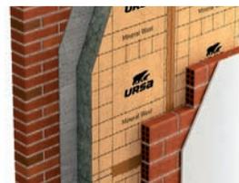
que con mortero cementoso hidrofugado en una capa continua sobre todo el soporte. El aislamiento se trasdosa posteriormente con placas de yeso laminado o doble pared de fábrica para completar el sistema.
