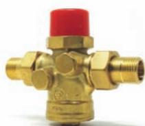
extremadamente compacto, es capaz de regular el caudal y mantenerlo constante ya que las condiciones de presión diferencial varían dentro del circuito hidráulico en el que está instalada. La válvula se puede utilizar con dos modos de funcionamiento: con control independiente de la presión (con actuador K281 instalado) o en modo limitación del caudal y/o cierre del flujo (con o sin actuador termoeléctrico R473 instalado).
