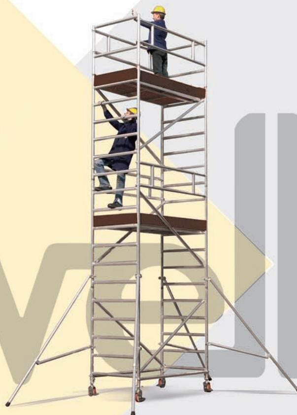
JOLLY Andamio modular con composiciones que llegan hasta los 10,62 m de altura de plataforma. Ganchos rápidos de seguridad, barandillas en H y acceso a la plataforma por el interior del andamio. Cumple la norma EN1004
