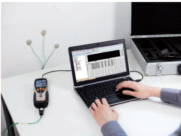
Cálculo del coeficiente de transmisión de calor mediante sonda, instrumento conectado al PC y software de análisis
